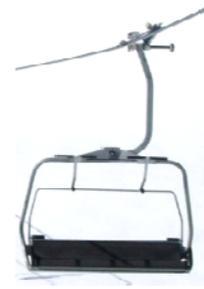
Exemple de véhicule à quatre sièges
