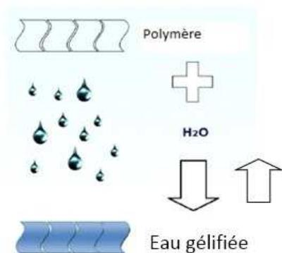
La poudre est constituée d'un ensemble de chaînes de polymères, entre lesquelles les molécules d'eau migrent. Cette eau ne s'évapore pas et ne s'infiltré pas dans le sol. Le polymère peut ensuite restituer jusqu'à 95% de l'eau qu'il a absorbée.
