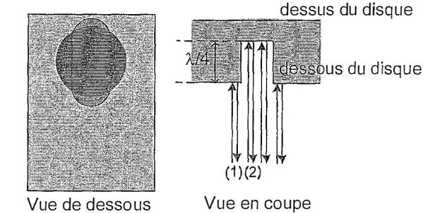
Le faisceau laser est positionné en face d'une cuvette : le rayon (1) situé au bord du faisceau se réfléchit sur un plateau, tandis que le rayon (2) situé au centre du faisceau se réfléchit dans une cuvette.
