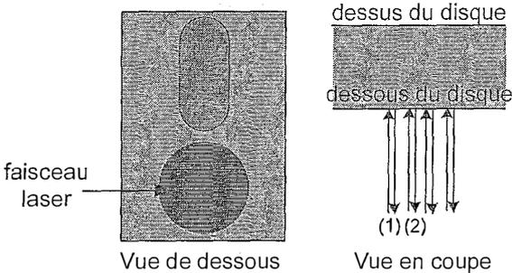
Le faisceau laser se réfléchit totalement sur un plateau.
