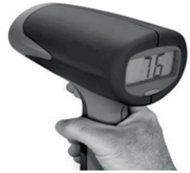
Figure 2. Radar portatif utilisé lors de la mesure de la vitesse (indiquée en \text{km.h}^{-1} ).
