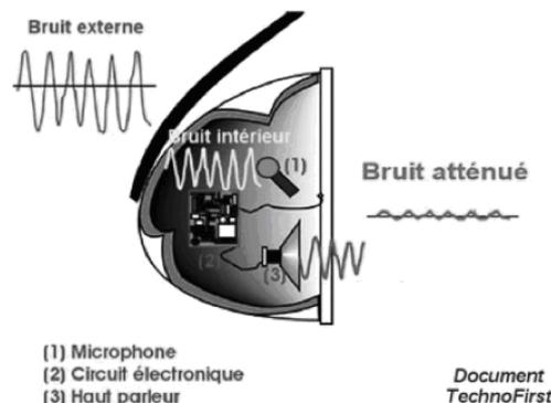
La technologie ANR® repose sur un système électronique miniaturisé (2) placé à l'intérieur de la coquille du casque. Ce système est connecté d'une part à un petit microphone (1) qui capte le bruit ambiant et d'autre part à un petit haut parleur (3) qui génère le « contre bruit » à proximité de l'oreille de façon à atténuer considérablement le bruit qui arrive au tympan.
