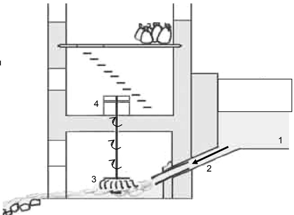
Un broyage nécessite le passage de 2 tonnes d'eau dans la conduite.
