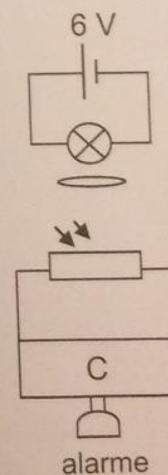
L'alarme s'active lorsque le « circuit de contrôle » C détecte une diminution importante de l'intensité électrique dans le circuit.
