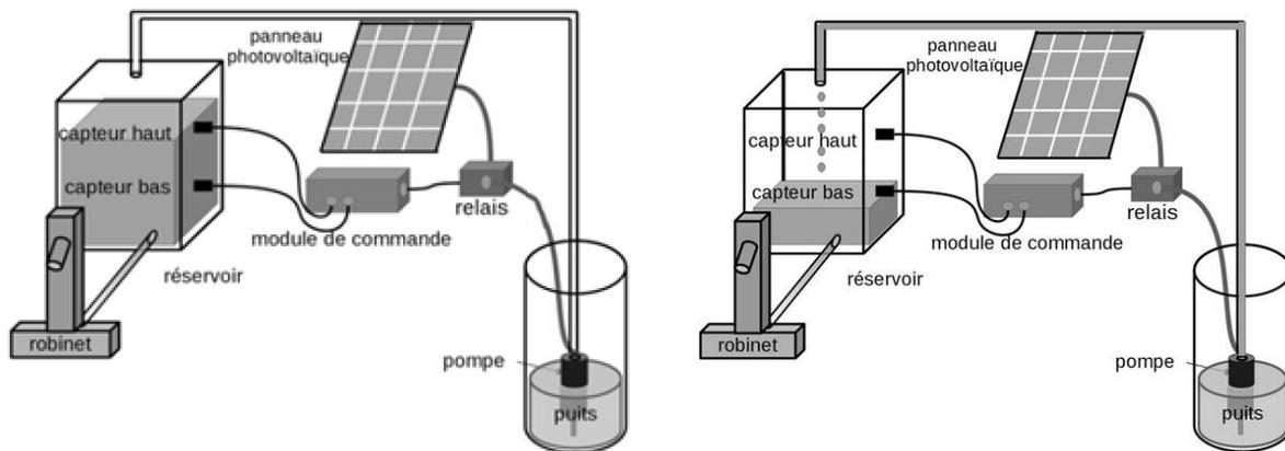
Lorsque le niveau de l'eau dans le réservoir atteint le capteur haut, l'ordre est donné d'arrêter la pompe.
